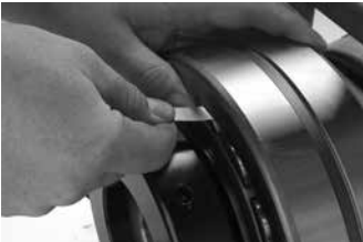
Mesure du jeu interne radial avant le montage
