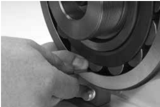
Après le montage, le jeu interne radial doit être vérifié sur le rouleau déchargé.
